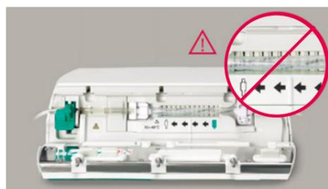
8. Vérifiez que la tubulure n'est pas tordue dans le segment de la pompe (les étoiles sont sur une ligne).
